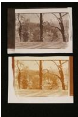
Obr. 2: Strahovský klášter z parku pod Petřínem. Každé ze tří polí obrazu bylo zcitlivěno jiným zcitlivovacím roztokem. Jedno pole roztokem čerstvě připraveným, druhé roztokem připraveným před rokem, třetí roztokem připraveným z nové dodávky chemikálií (pro zkoušku jejich kvality). Ve všech třech částech papíru vyšel obraz naprosto identicky. Zcitlivovací roztok, starý asi jeden rok, tedy pracoval stejně, jako čerstvý.
