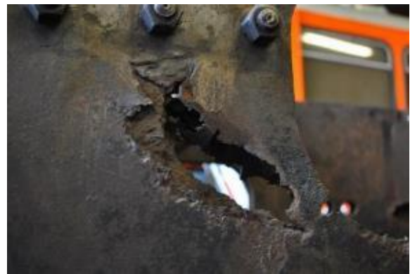
Příklad hloubkové koroze rámu lokomotivy
