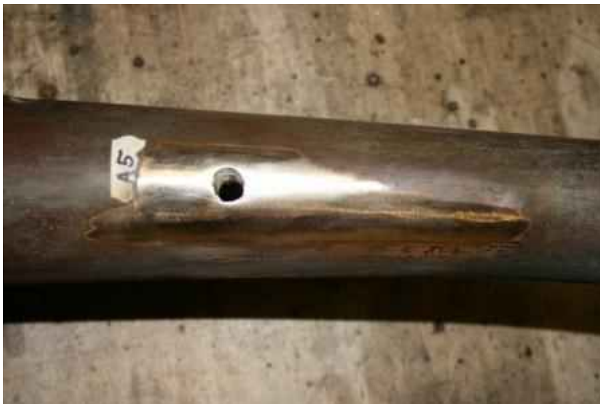
Stejné místo po zavaření a přebroušení sváru.
