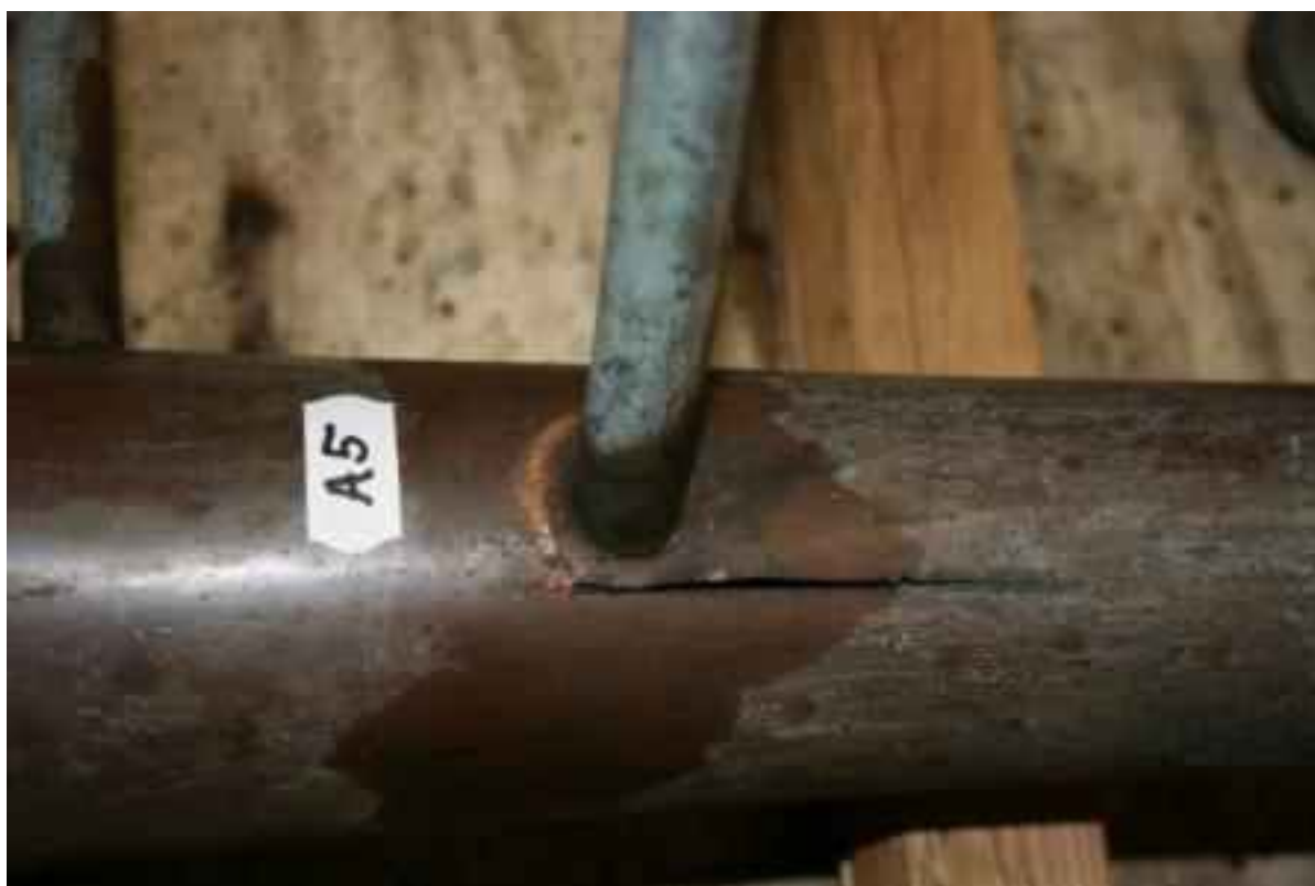
Prasklina těla fontány, zapříčiněná tlakem deformovaného ramínka.
